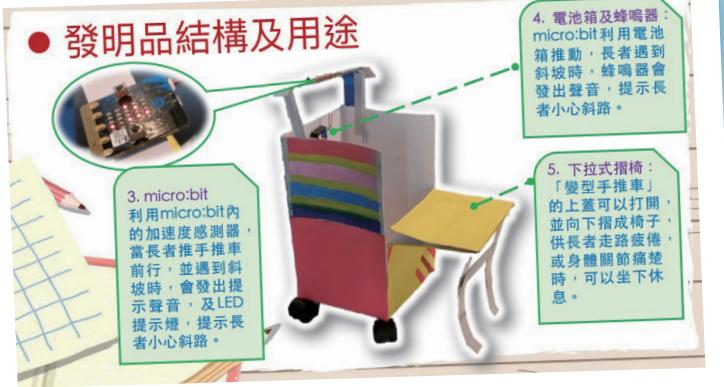
該校學生能於課餘時間參加多元化的 STEAM 興趣班，例如：mBot 小組、3D 打印小組、Gigo 機關王小組及智能發明小組。當中，智能發明小組同學更發揮天馬行空之創意，為家人製作一件能改善生活，方便長者的實用作品。學生劉沛喬看到患有退化性關節炎的祖母，手腳關節長期面對痛楚、紅腫；在走動、下斜路或拿重物時，情況尤其嚴重。於是她便發明了「變形手推車」，手推車的上蓋不但可揭開摺疊成一張椅子，當長者疲倦時可即時坐下休息舒緩身體上的疲勞和痛楚，而且還設置 micro:bit 加速度感測器，當長者推手推車遇到斜坡時，感測器會發出聲音，提示長者小心斜路，保障安全。
