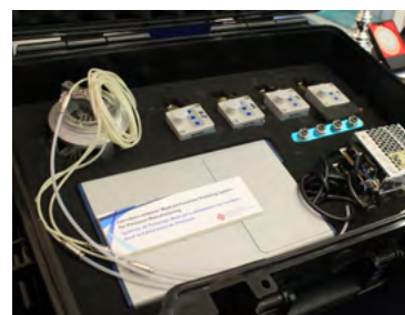
用於精密製造的曲率自適應多射流自由曲面拋光系統。
